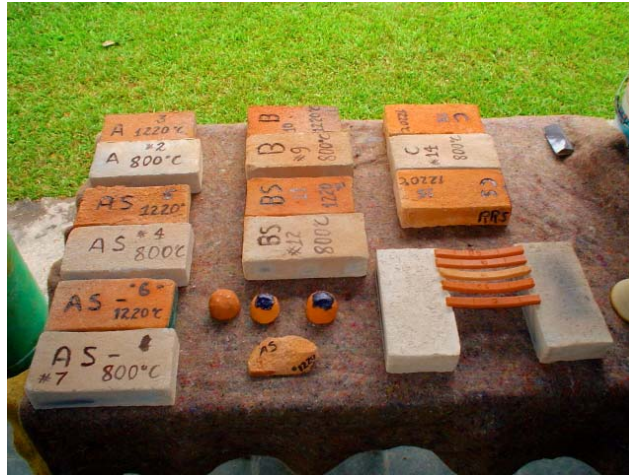
Figura 15. Experimentos com tijolos refratários artesanais usando diferentes massas e queimas. Foto: UFSJ/LCCM- Rogério Godoy.
