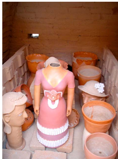
Figura 17. Interior do forno após a queima. Observa-se a preservação das cores das peças.
