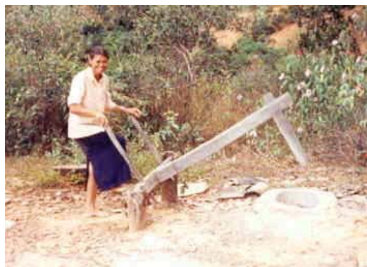
Figura 5. Da. Maria Pires, município de Minas Novas, usa a gangorra para pulverizar.
