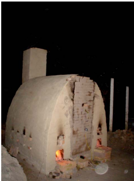
Figura 14. Forno em plena queima no momento em que se inicia a elevação da temperatura, após secagem das peças.
